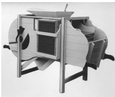
Wialnia „Gostynianka” zastępująca również młynek do sortowania zboża (po lewej), szatkownica do kapusty
