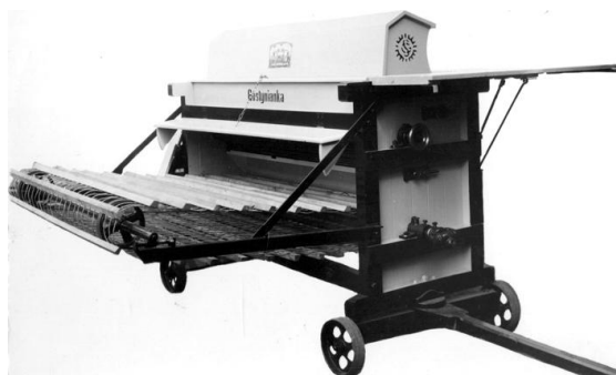
Młockarnia szerokomłotna drewniana lekka (po lewej), młockarnia szerokomłotna drewniana z wytrząsaczem lub z drabką
