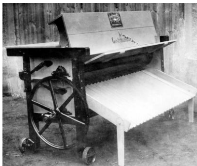
Młockarnia szerokomłotna drewniana lekka (po lewej), młockarnia szerokomłotna drewniana z wytrząsaczem lub z drabką
